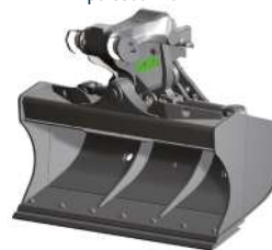
CONTRE-LAME BOULONNÉE RÉVERSIBLE Épaisseur 25 mm
